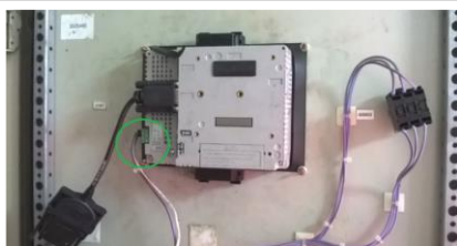
Detalle de la parte posterior de la pantalla. Sobre la imagen, resaltado la conexión de 24V a desconectar. Close-up of the rear of the screen with the 24 V connection to be removed marked in green.
